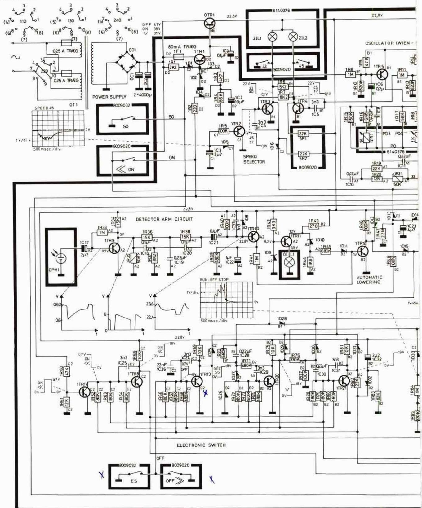
Alle DC spændinger er positive i forhold til stel, og de er målt med roterende pladetallerken, med hævet pick-up arm og med detektorarmen inde over en plade. Spændingerne er målt med voltmeter med en indre modstand på mindst 2 Mohm.
