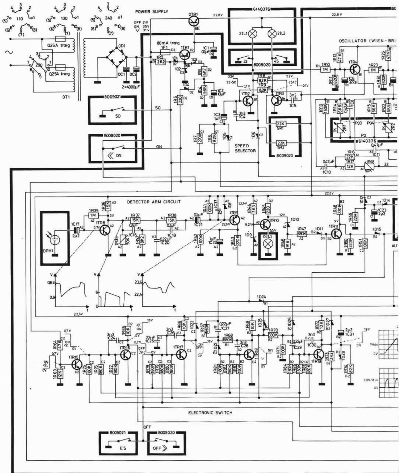
Alle DC spændinger er positive i forhold til stel, og de er målt med roterende pladetallerken, med hævet pick-up arm og med detektorarmen inde over en plade.
