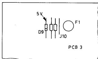
Et DC-voltmeter tilsluttes 5V forsyningsspændingen (anoden af 3D9). Spændingen skal være inden for 4,8V-5,25V. Hvis spændingen er højere end 5,25V, klippes J10.
