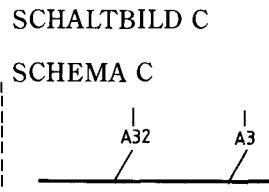
Une connexion vers une autre page de schéma est indiquée par un chiffre et par une lettre indiquant le schéma que la connexion relie.
