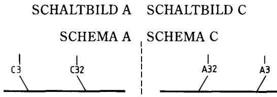
Eine Verbindung an eine andere Schaltbildseite wird mit einer Nummer sowie einem Buchstaben des Schaltbildes, an das die Verbindung geht, angegeben.
